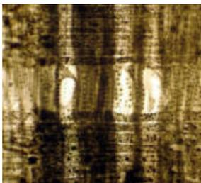
**Рис. 1.** Радиальный срез в зоне ранней древесины. По центру – ранние сосуды окруженные волокнистыми трахеидами. Сверху и снизу располагаются лучи. Окраска клеточных стенок – желто-бурая. Объектив: С-Plan 12,5/0,3, ∞/0,17. Неокрашенный препарат
