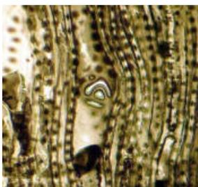
**Рис. 2.** Тангентальный срез в зоне поздней древесины. Видны контрастированные темные полости всех пор. Объектив: С-Plan 40/0,65, ∞/0,17. Неокрашенный препарат
