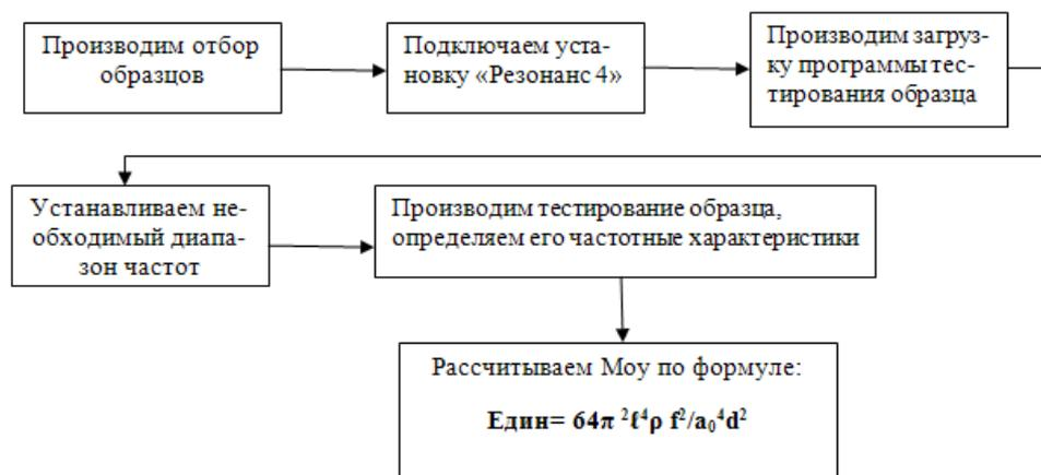
Рис. 2. Алгоритм методики определения динамического модуля упругости вибрационным методом
