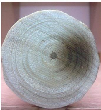
Рис. 1. Обугленная зона древесины
