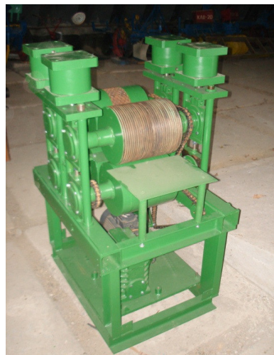
Рис. 1. Установка для раздавливания древесины
