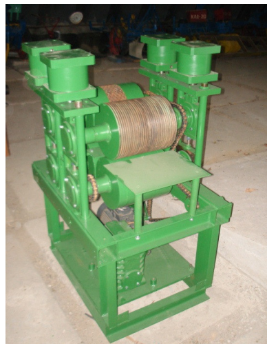
Рис. 1. Установка для раздавливания древесины
