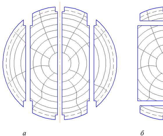
**Рис. 2.** Схема раскря пиловочника, пораженного радионуклидами: а – первый проход; б – второй проход
