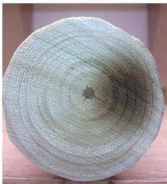
Рис. 1. Обугленная зона древесины
