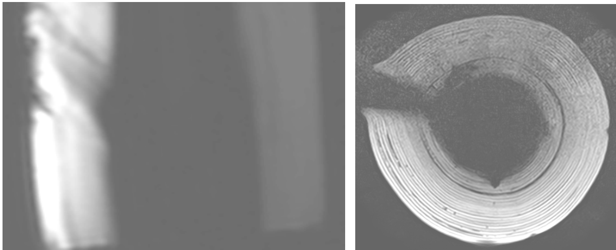
Рис. 1. Магнитно-резонансные томограммы (МРТ) внутреннего состояния ствола дерева (темное поле – W \leq 60\% , светлое поле W > 60\% )
