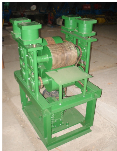
Рис. 1. Установка для раздавливания древесины
