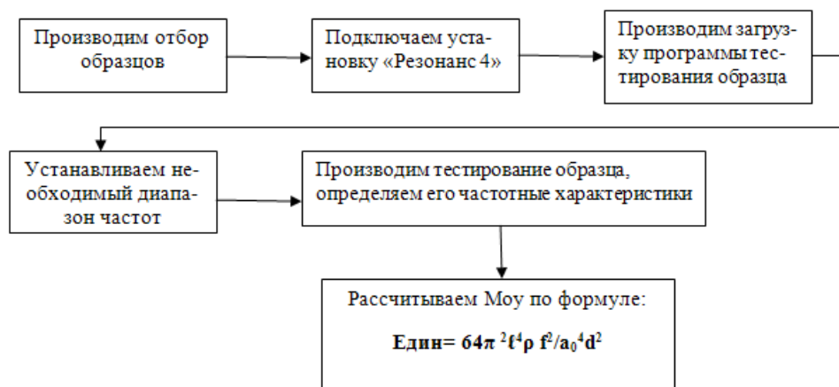
Рис. 2. Алгоритм методики определения динамического модуля упругости вибрационным методом
