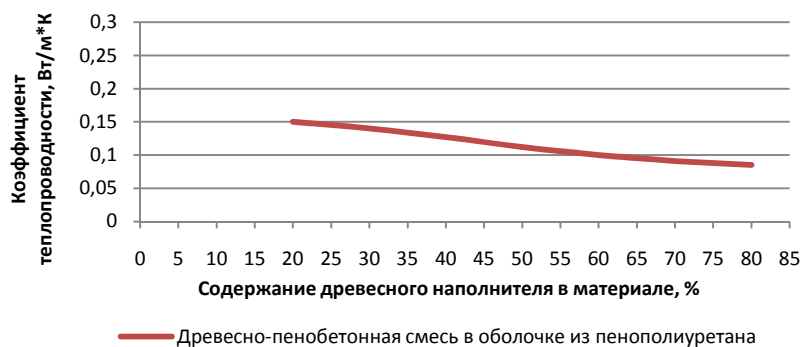
Рис. 2. Характеристика теплопроводности от содержания древесного наполнителя
