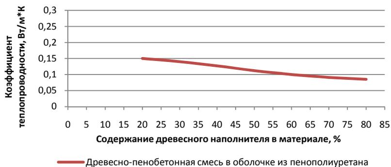
Рис. 2. Характеристика теплопроводности от содержания древесного наполнителя
