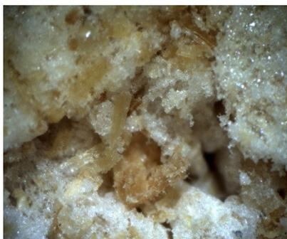
Рис. 3. Микроструктура древесно-полимерного композита 30–35 % опилок
