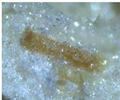
Рис. 2. Микроструктура древесно-полимерного композита 20–25 % опилок
