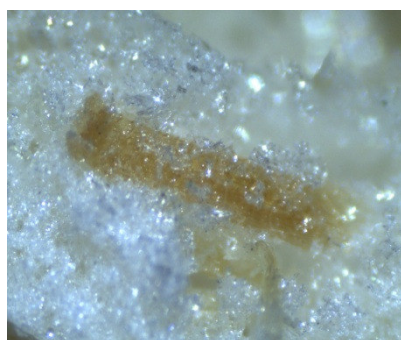
Рис. 2. Микроструктура древесно-полимерного композита 20–25 % опилок
