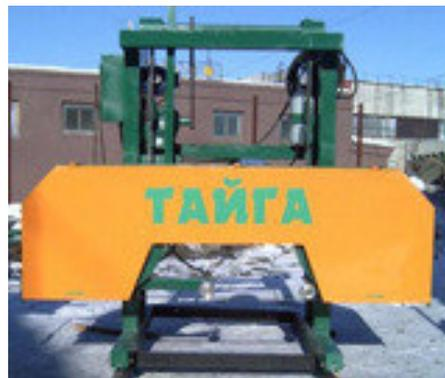
Рис. 4. Ленточнопильный станок «Тайга»
