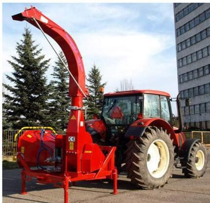
Рис. 5. Дробилка на базе трактора
