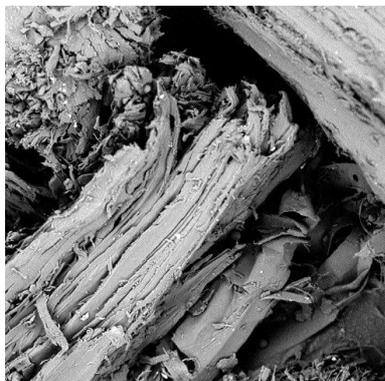
**Рис. 8.** Микрофотография древесных опилок после проведения механоактивации ( $\times 1000$ )
