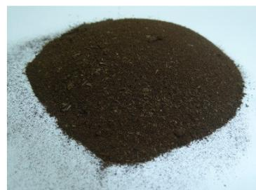
**Рис. 4.** Гидролизный лигнин до проведения механоактивации
