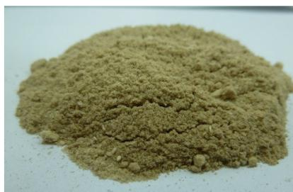
**Рис. 5.** Древесные опилки после проведения механоактивации
