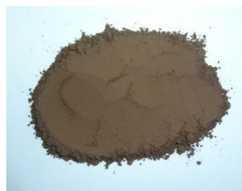
**Рис. 7.** Гидролизный лигнин после проведения механоактивации
