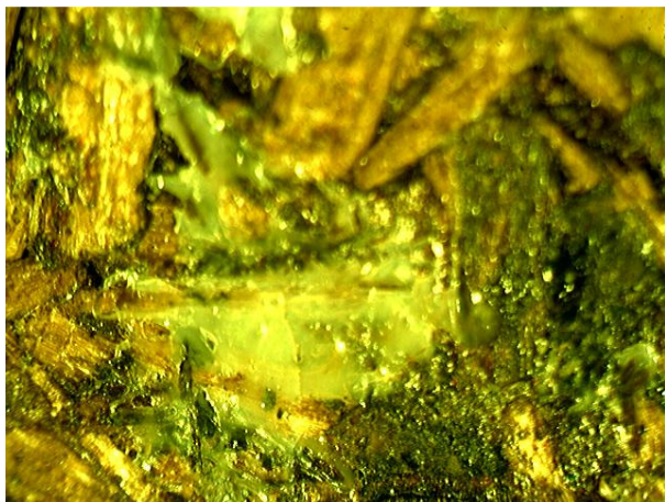
Рис. 1. Структура композита с добавкой измельченных полиэтиленовых отходов (температура прессования 210 °С)
