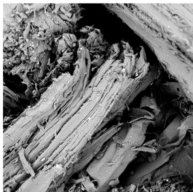
Рис. 8. Микрофотография древесных опилок после проведения механоактивации ( \times 1000 )
