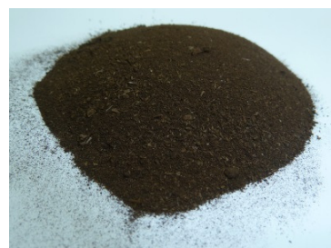
Рис. 4. Гидролизный лигнин до проведения механоактивации
