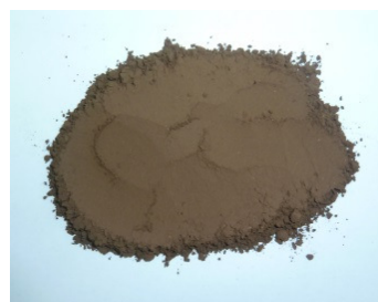
Рис. 7. Гидролизный лигнин после проведения механоактивации
