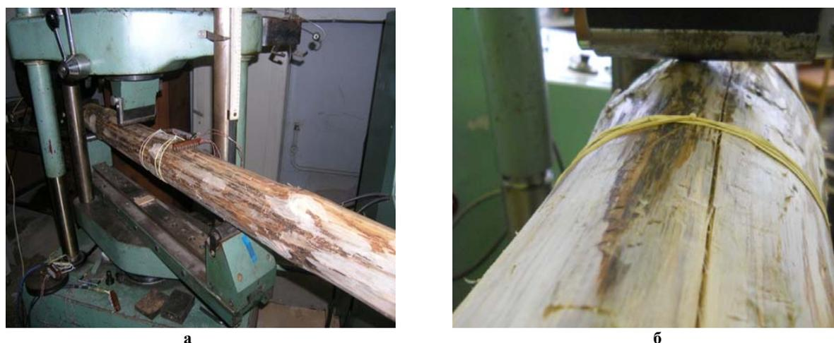
**Рис. 3. Испытания образцов круглых лесоматериалов на статический поперечный изгиб:**
