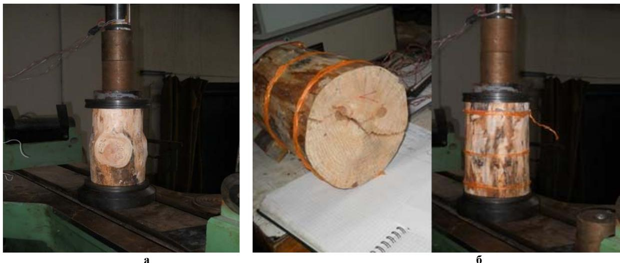
**Рис. 2. Испытания образцов круглых лесоматериалов на предел прочности при сжатии вдоль волокон:**
