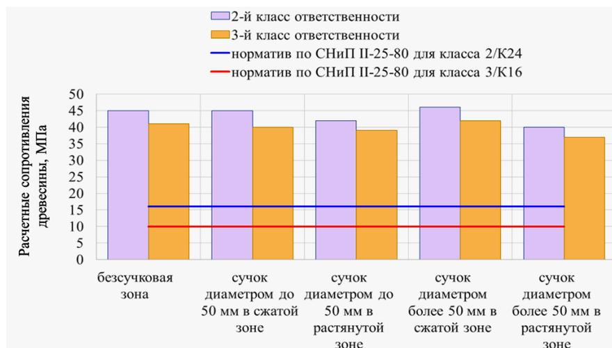
Рис. 4. Расчетное сопротивление древесины на изгиб в балках с сучками
