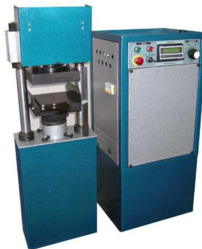
Рис. 2. Испытательный пресс ИПЭ-100
