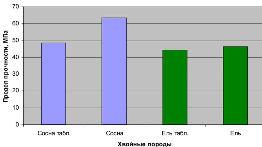
Рис. 3. Гистограмма пределов прочности древесины хвойных пород при сжатии вдоль волокон
