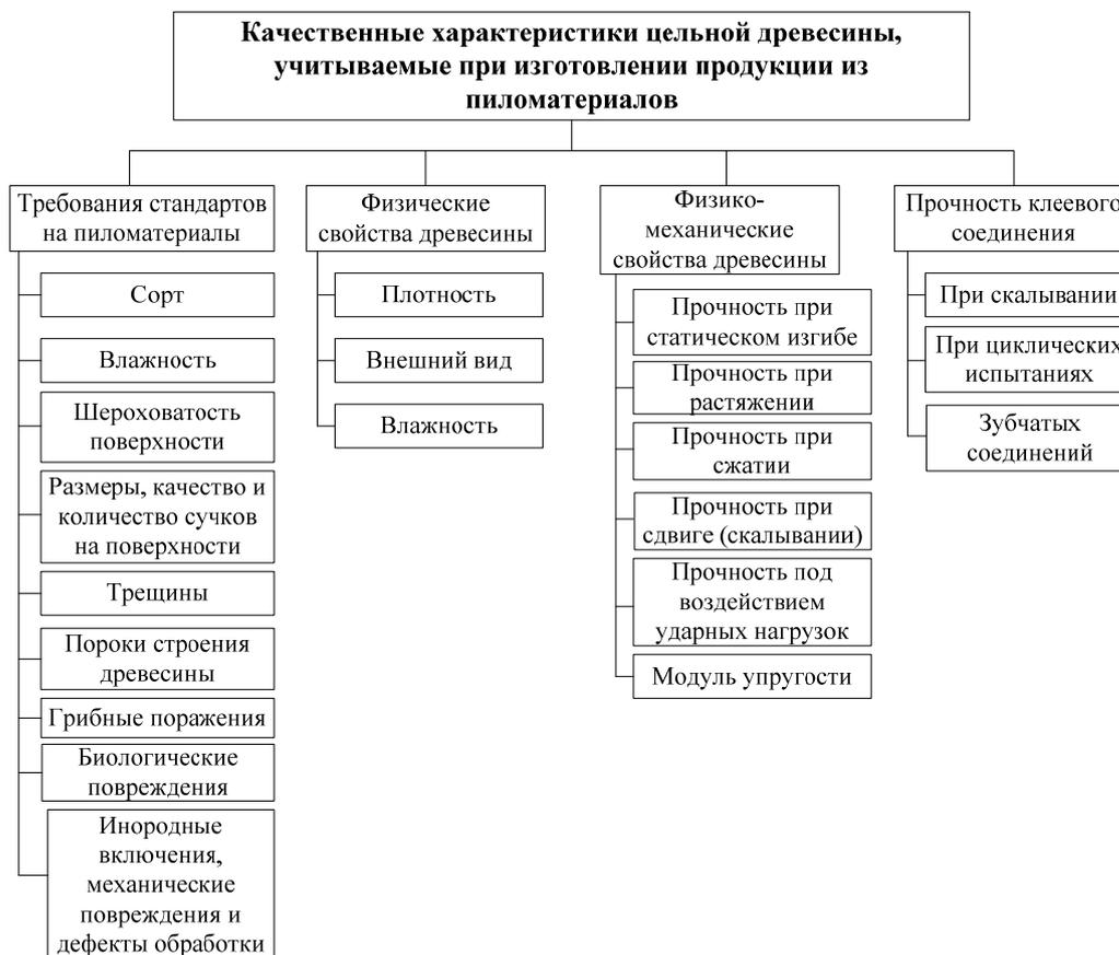
**Рис. Качественные характеристики древесины, учитываемые при изготовлении продукции из пиломатериалов и композиционных древесных материалов**
