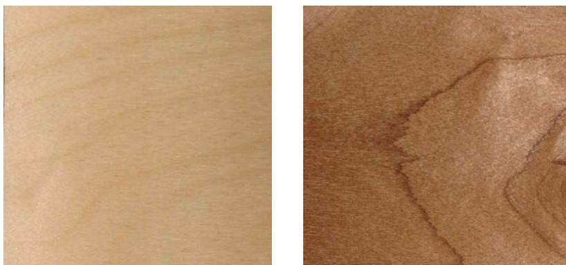
Рис. 1. Образцы березового лущеного шпона: обычного и термомодифицированного
