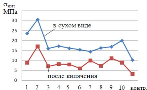
Рис. 2. Изменение прочности при статическом изгибе образцов ДСтП
