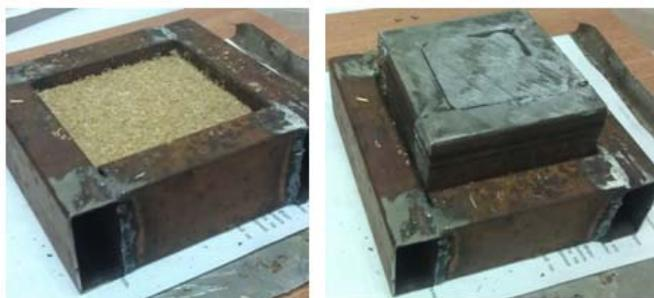
Рис. 1. Пресс-форма для изготовления древесно-стружечной плиты
