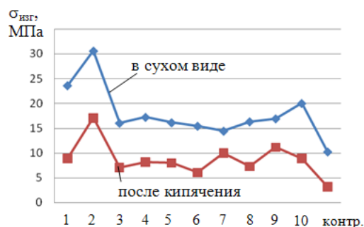
Рис. 2. Изменение прочности при статическом изгибе образцов ДСтП
