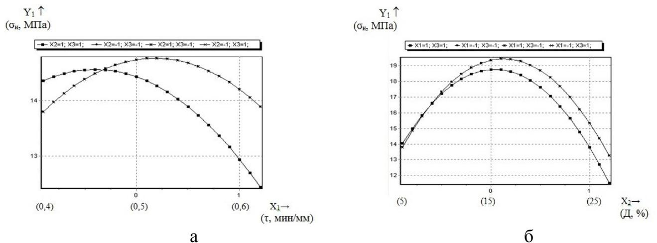
Рис. 1. Зависимости прочности плит: а - от удельной продолжительности прессования; б - от доли добавки алюмохромфосфата
