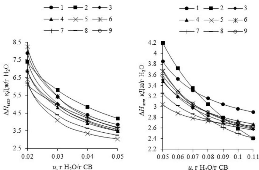
**Рис. 3. Зависимость энтальпии испарения связанной воды, найденная по результатам ДСК при нагревании древесины от 25 до 200 °С со скоростью 10 °С/мин в атмосфере воздуха: при водосодержании  $u \leq 0,05$  (слева) и при  $0,05 \leq u \leq 0,11$  г  $H_2O$ /г СВ (справа). 1 – дуб; 2 – бук; 3 – граб; 4 – робиния; 5 – липа; 6 – ясень; 7 – клен; 8 – ольха; 9 – осина**
