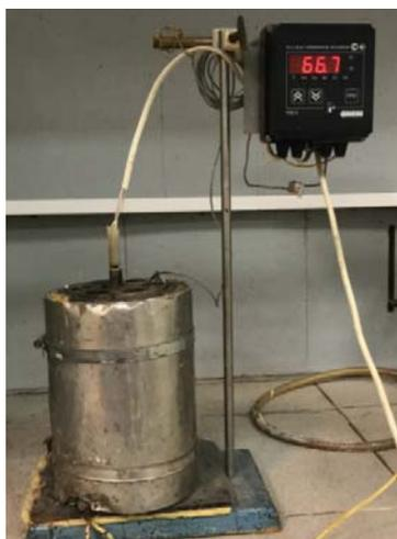
**Рис. 1. Гидролизер капсульного типа с металлическим тепловым аккумулятором**
