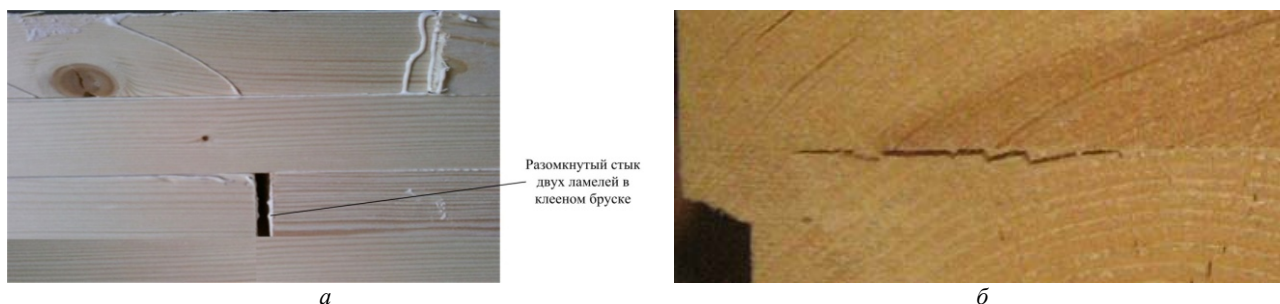
Рис. 1. Клееные материалы, имеющие дефекты склеивания:
