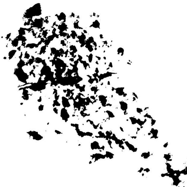
Рис. 44 Бинарное изображение поперечного сечения бескруточной ровницы
