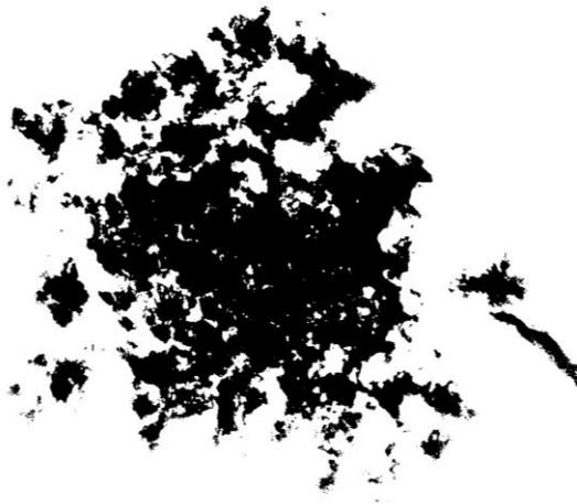
Рис. 43 Бинарное изображение поперечного сечения крученой ровницы
