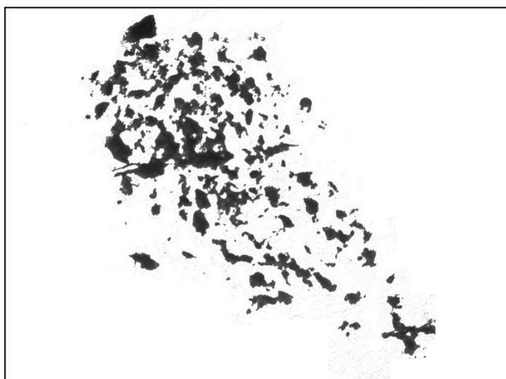
Рис. 41. Монохромное изображение поперечного сечения бескруточной ровницы
