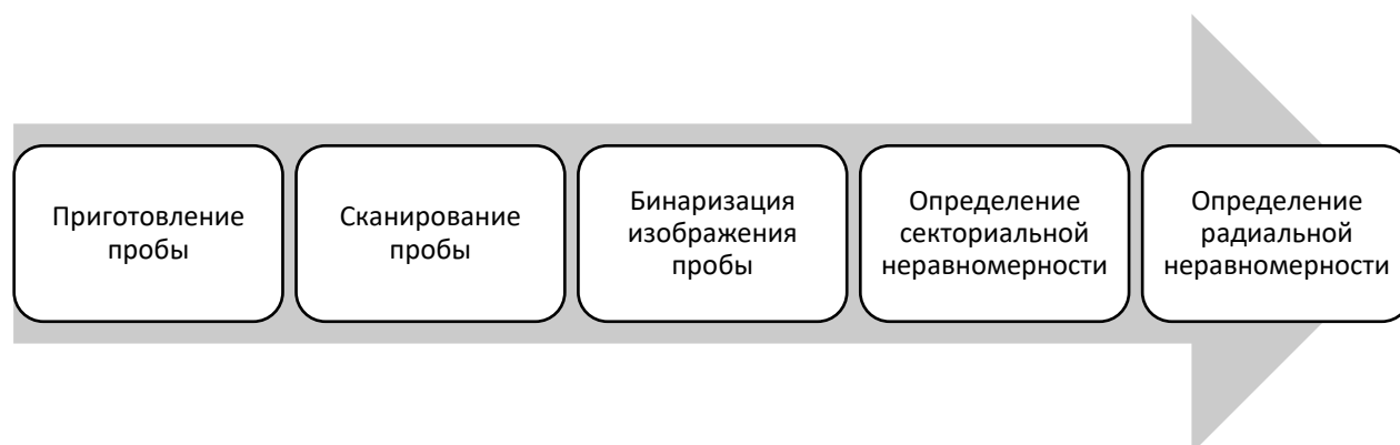
Рис. 5.6 – Последовательность операций методики цифрового исследования поверхностной плотности прочёса при производстве геополотна
