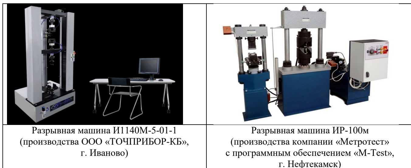
Рис. 5.11 - Отечественные автоматизированные средства измерений показателей прочности и удлинения материалов при деформации растяжения
