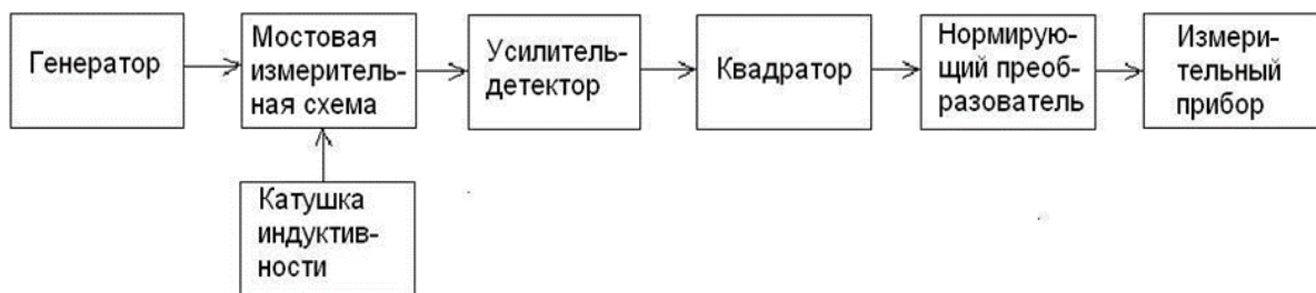
Рис. 5.15 – Структурная схема измерительного преобразователя
