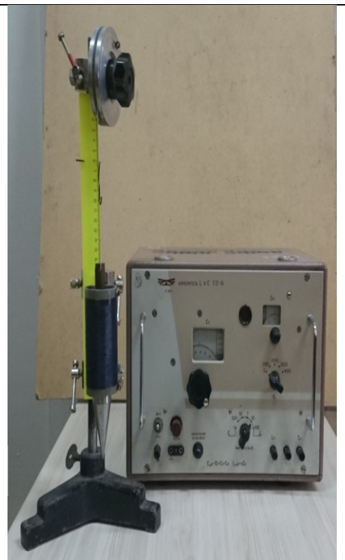
Рис. 5.14 – Макет устройства для исследования характеристик измерительного преобразователя
