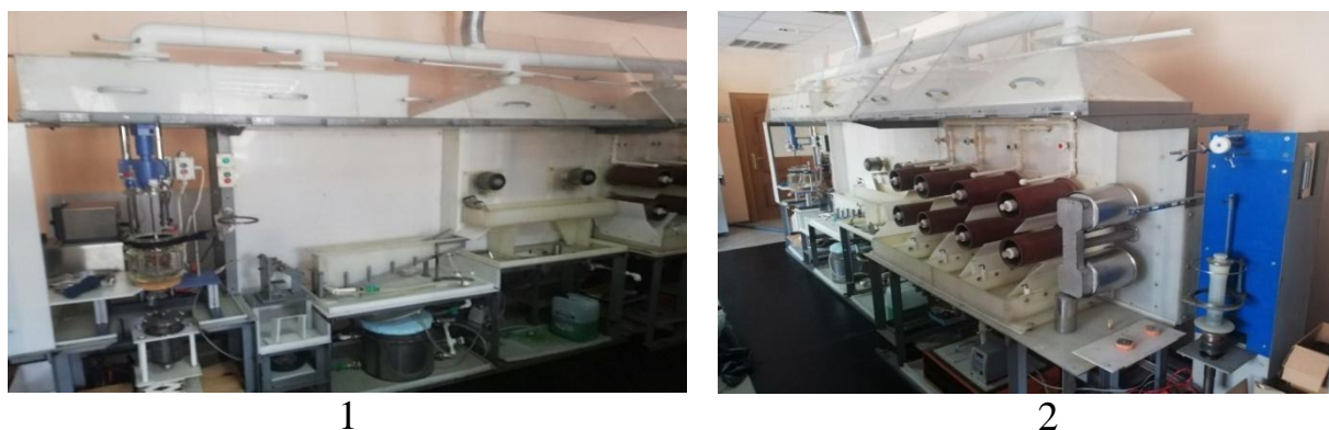
Рис. 3. Опытная установка: 1) узел полимеризации и формования; 2) узел намотки
