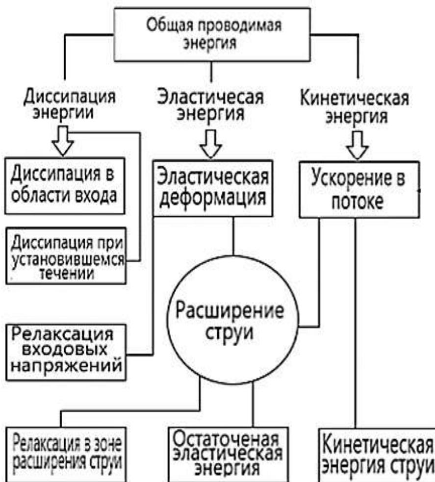
Рис. 12 - Схема преобразования общей проводимой энергии в фильере при формировании волокон
