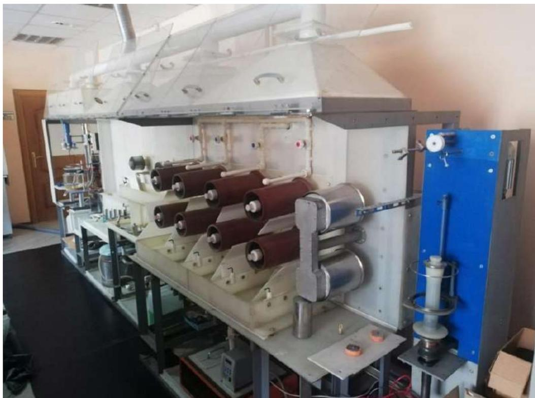
Рис. 18 - Установка – узел полимеризации и формования
