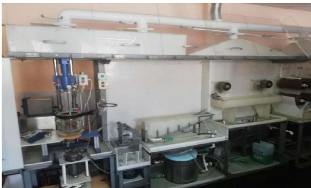
Рис. 17 - Установка – узел намотки
