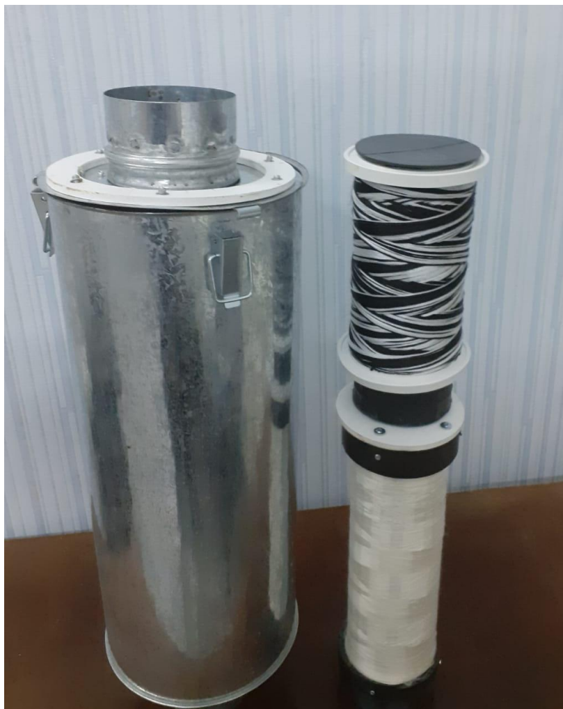
Рисунок 6.10 — б) Фото композиционного фильтра коллекторного типа для очистки и обеззараживания воздуха.
