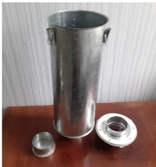
Рисунок А 2 - Корпус фильтра коллекторного типа в разборе
