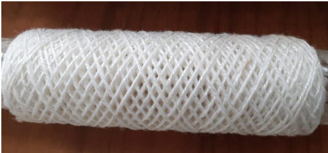
Рисунок 2.11 — Фото 23-х замкнутой намотки.
