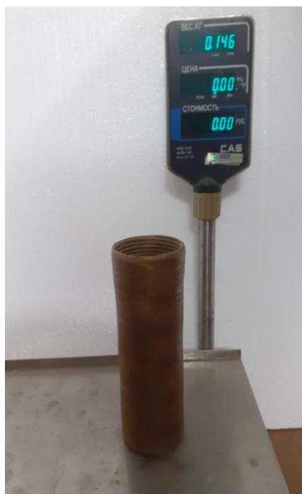
Рисунок 2.5 б) — Оболочка сомкнутой структуры намотки в виде конечного продукта
