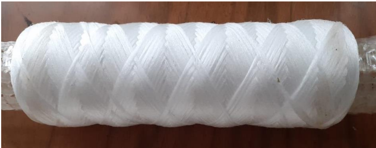
Рисунок 2.2 — Фото 3х сомкнутой структуры намотки нитей на паковку.
