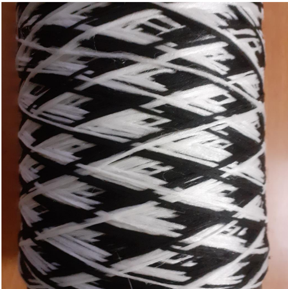
Рисунок 2.17 — Фото 13-ти сомкнутой 3D намотки, сформированной двумя системами нитей (черные и белые).
