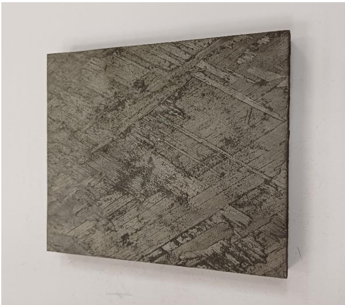
Рисунок 6.12 — Развертка сомкнутой намотки волокна UMT – 12K.
