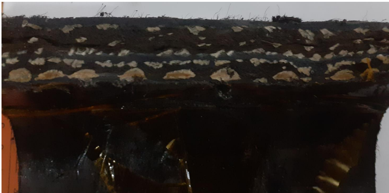
Рисунок 2.20 — Фотография разреза толстостенной (толщиной 20 мм) 3D сомкнутой намотки, сформированной из углеродных и вискозных нитей различной линейной плотности.
