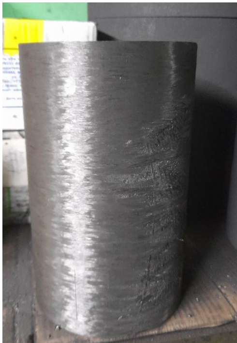
Рисунок 6.3 — Заготовка под ФКУМ методом намотки.
