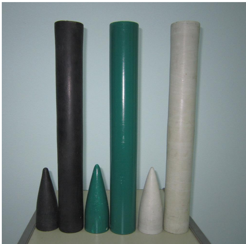
Рисунок 2.5 а) — Оболочки сомкнутой структуры намотки в виде конечных продуктов
