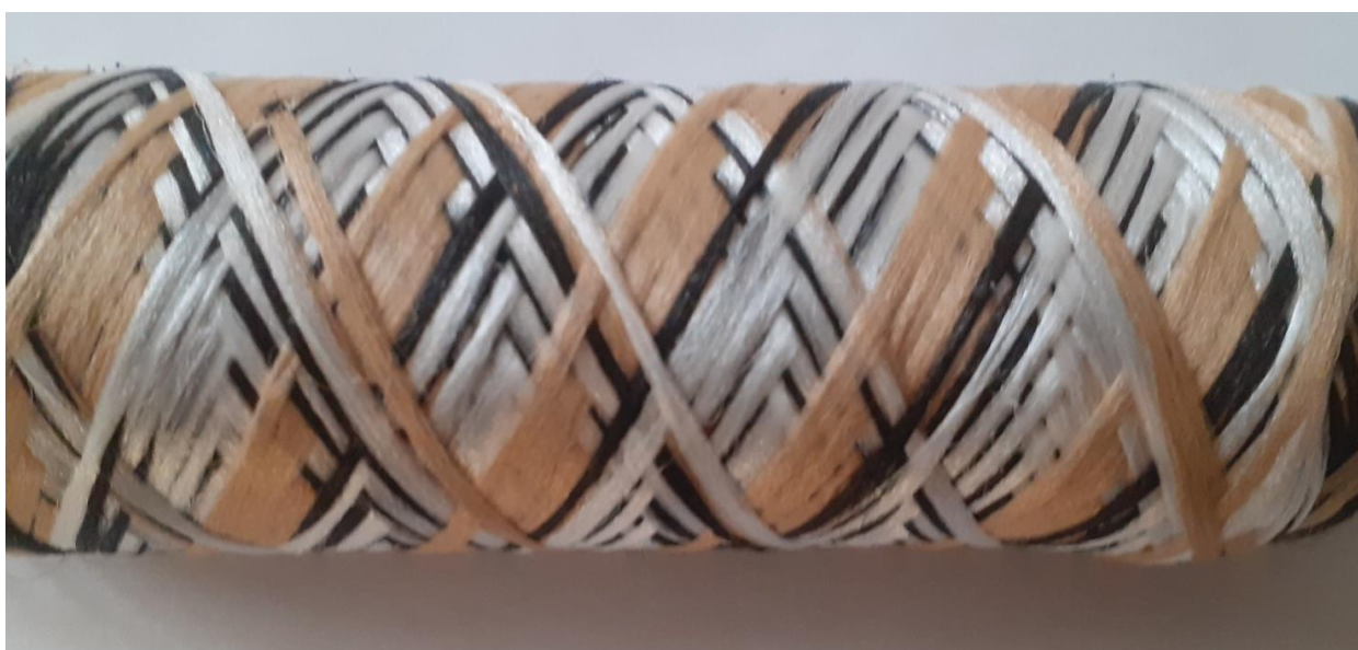
Рисунок 2.18 — Фото 3-х сомкнутой 3D намотки, сформированной тремя системами нитей (черные, оранжевые и белые).
