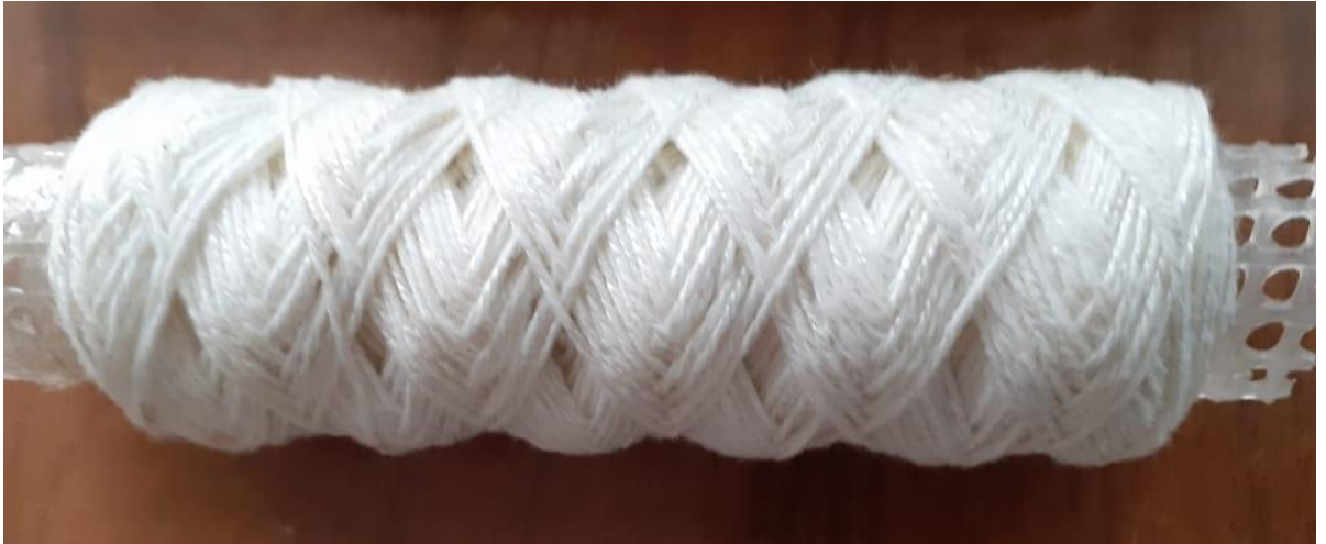
Рисунок 2.12 — Фото спиралевидной намотки.
