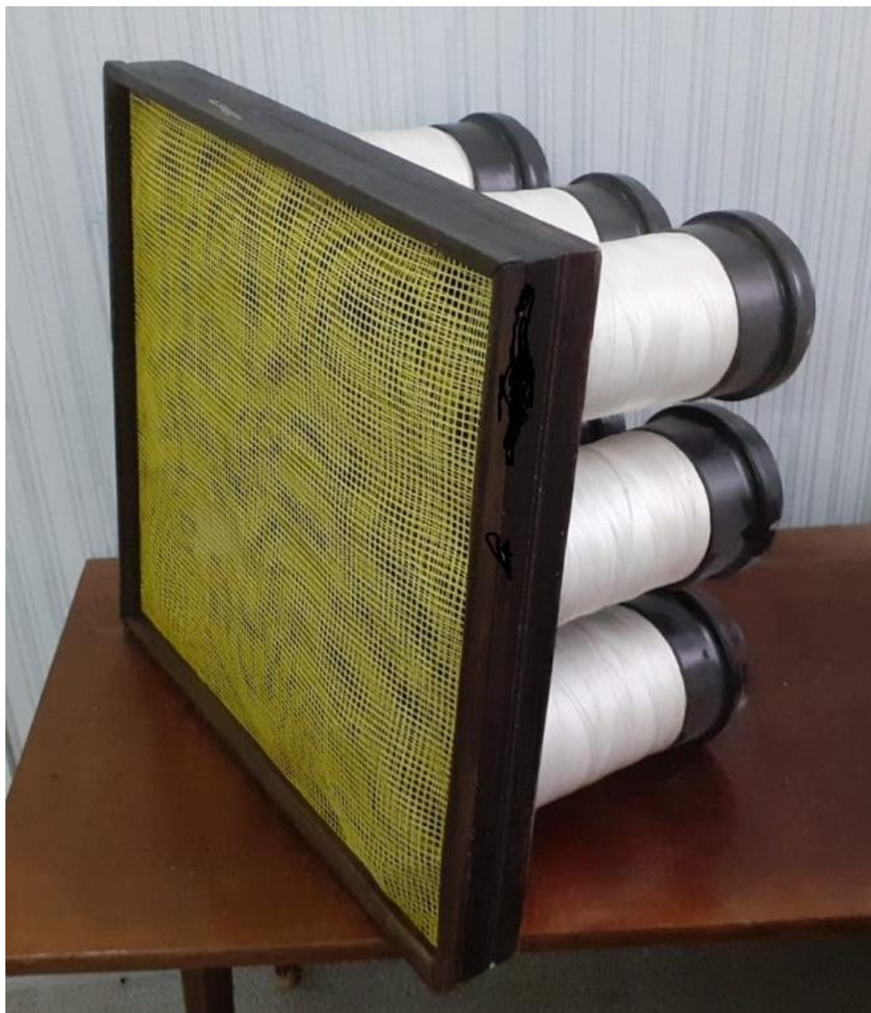
Рисунок 6.10 — а) Фото композиционного фильтра рамочного типа для очистки и обеззараживания воздуха.
