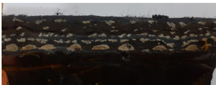
Рисунок 10 - Фотография разреза толстостенной (толщиной 20 мм) 3D структуры сомкнутой намотки, сформированной из углеродных и вискозных нитей различной линейной плотности.
