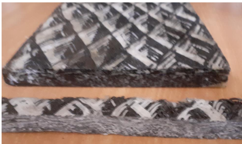
Рисунок 11 - Фото и разрез развертки 3D сомкнутой намотки
