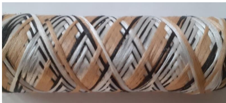
Рисунок 9 - Фото 3-х сомкнутой 3D намотки, сформированной тремя системами нитей (черные, оранжевые и белые).
