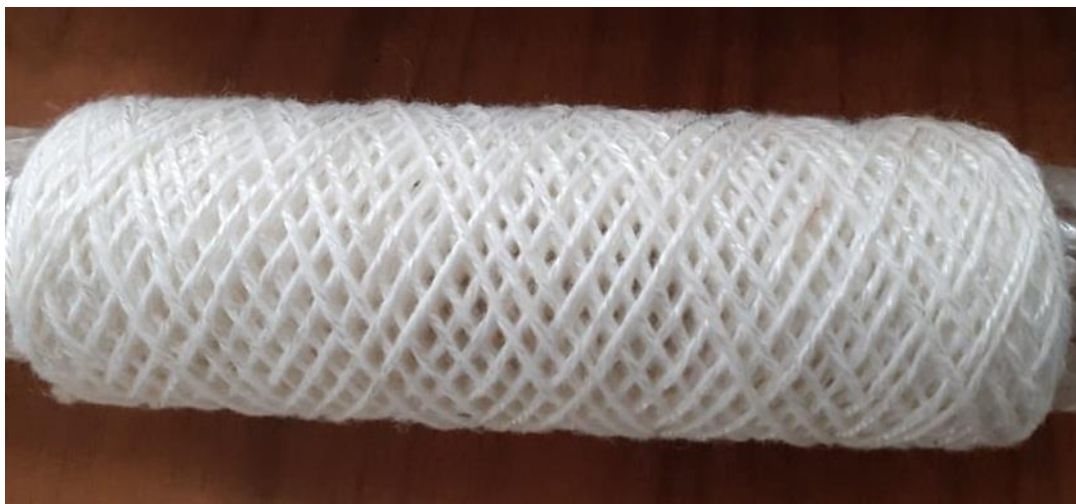
Рисунок 4 - Фото замкнутой структуры намотки.
