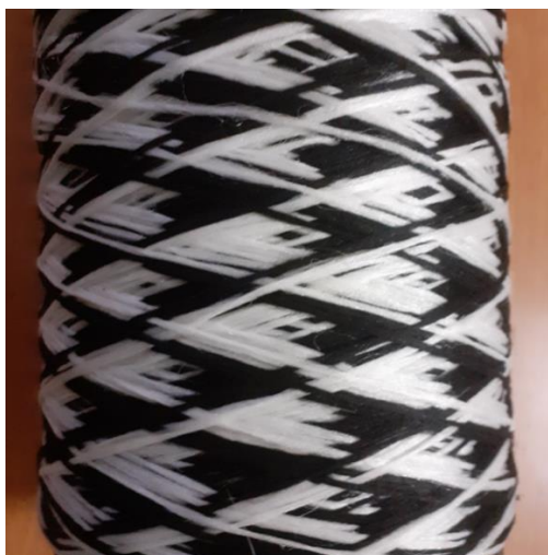
Рисунок 8 - Фото 13-ти сомкнутой 3D намотки, сформированной двумя системами нитей (черные и белые).
