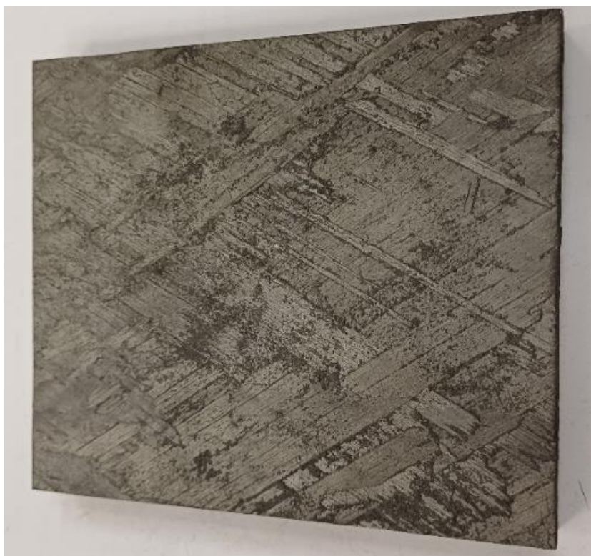
Рисунок 12 - Развертка, сформированная намотки УУКМ с углом скрещивания витков 60^{\circ} .
