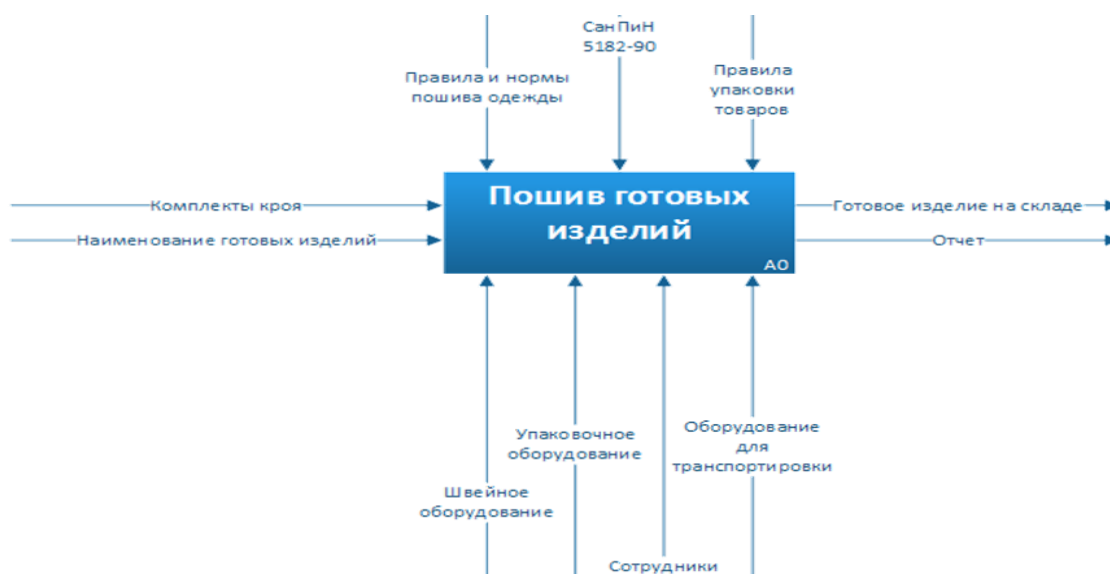
Рисунок 3.17 – Диаграмма реализации модуля «пошив готовых изделий» ИАС
