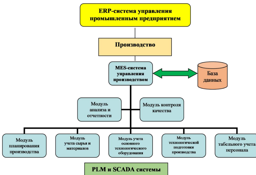
Рисунок 2.11 – Архитектура ИАС управления современным предприятием текстильной и легкой промышленности
