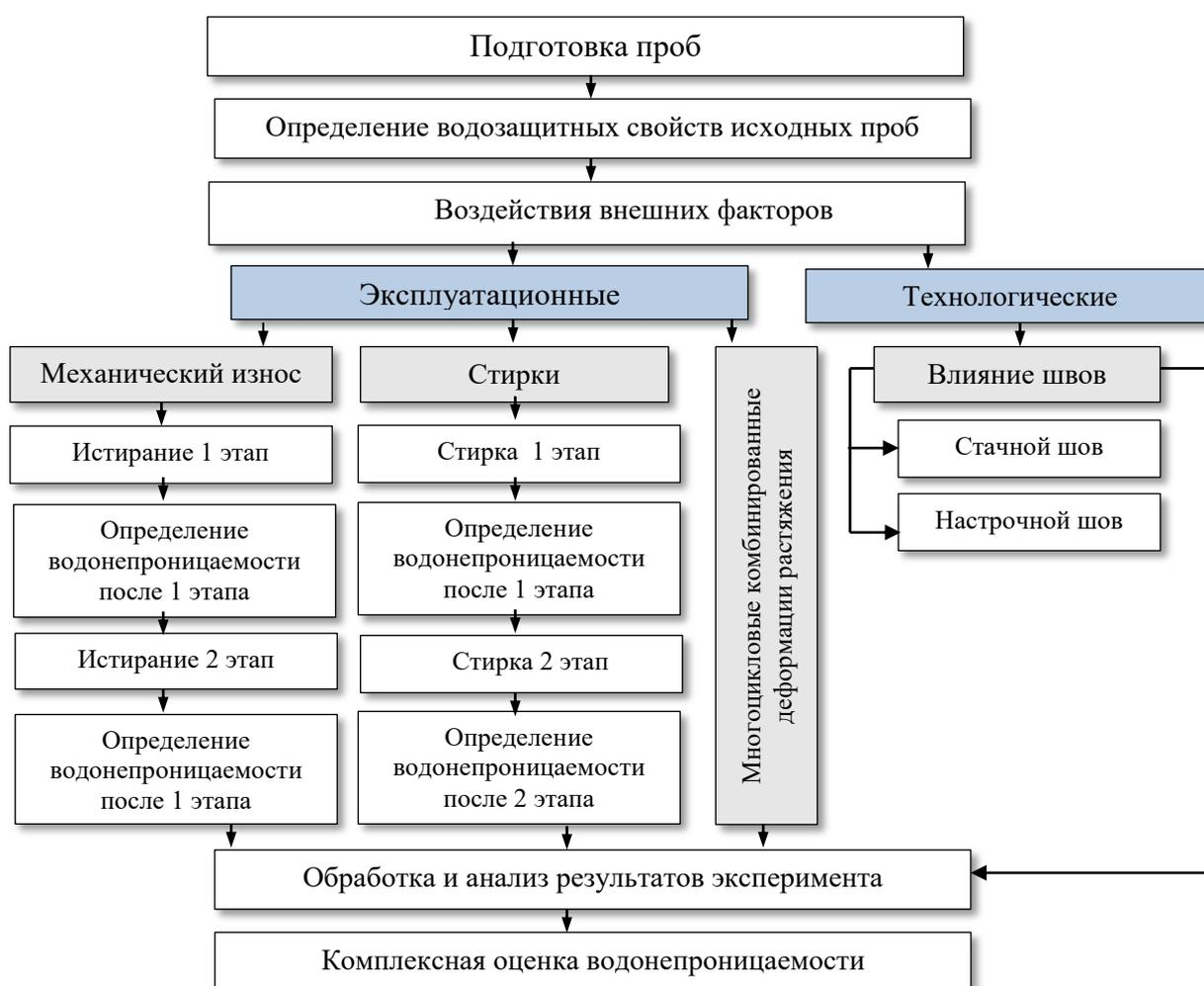
Рисунок 4.11 – Схема методики исследования водозащитных свойств материалов
