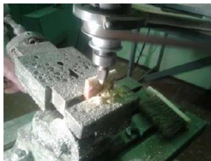
Рис. 3. Фрезерование опытных образцов из ПКМ на гравировально-фрезерном станке 6Г463
