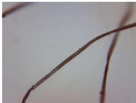
Рис. Структура регенерированного волокна при 10-ти кратном увеличении
