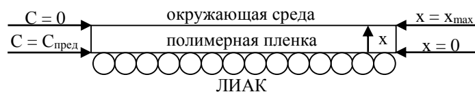
Рис. 1. Схема проникания ЛИАК через полимерную пленку
