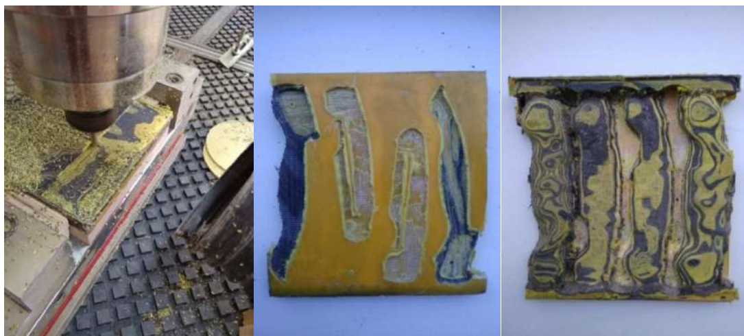
Рис. 4. ЧПУ обработка накладок рукоятей складных ножей на фрезерном станке Dekart1530
