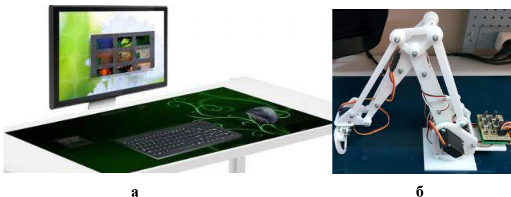
Рис. 2. Роботизированный комплекс контроля качества продукции: а – рабочее место контролера, б – робот-манипулятор
