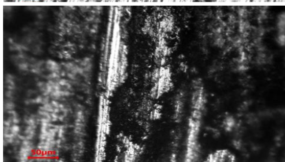
Рис. 6. Дорожка трения на необработанном титановом образце. Путь трения: а – 100 м; б – 900 м
