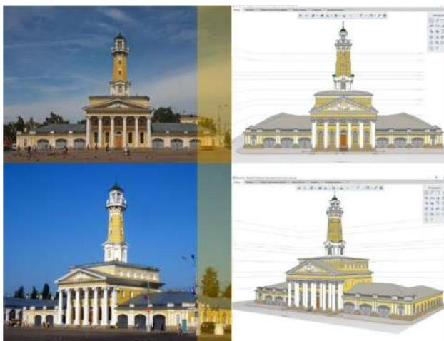
Виды, размещенные на чертеже, это автоматически полученные с 3d-модели проекции, которые ассоциативно связаны с моделью. Любое изменение модели моментально изменяет геометрию на чертеже. Режим «Чертеж» – полноценный графический редактор, позволяющий пользователю дополнить чертежи нужными графическими примитивами: отрезки, дуги, штриховки, заливки, высотные отметки, линейные размеры и др.
