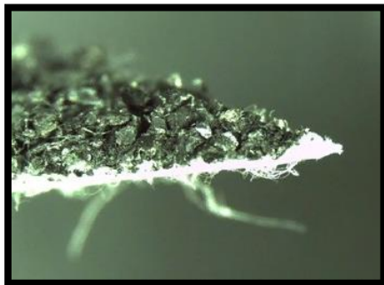
Рисунок 1. Активный уголь в составе нетканого волоконистого материала
