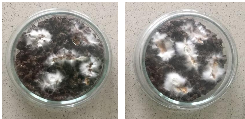
Рис. 1. Третий (слева) и седьмой (справа) день культивирования мицелия P. ostreatus на субстрате из отходов текстильных производств
