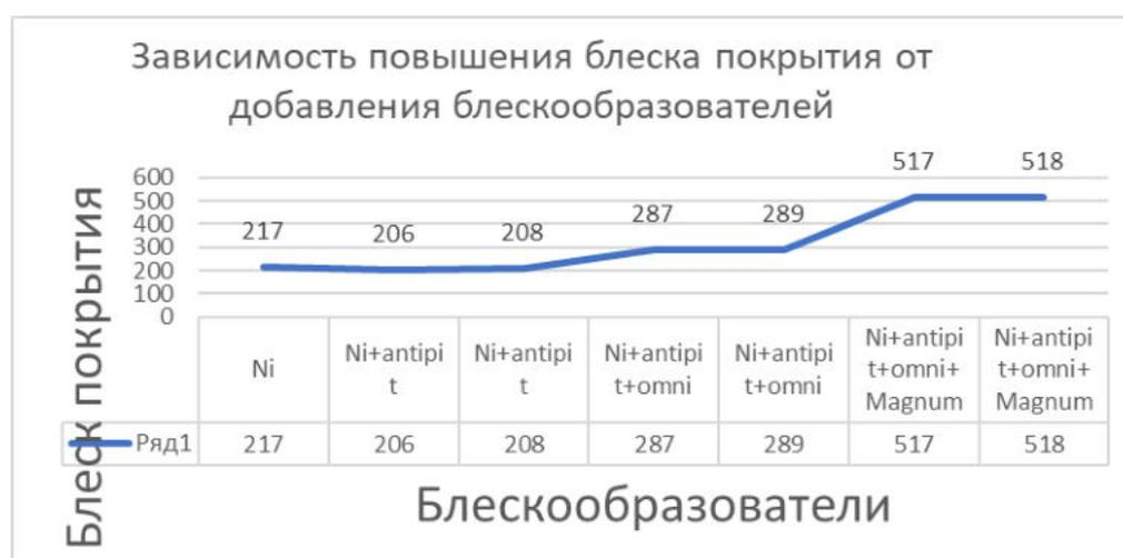
Рис. 2. Влияние блескообразователей на блеск никелевого покрытия.
