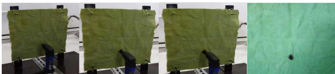
Рисунок 3 – Образец с огнезащитным составом
