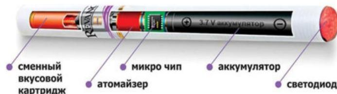
Рисунок 1. Устройство электронной сигареты
