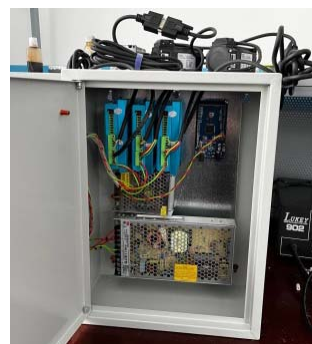
Рис. 2. Собранный шкаф управления
