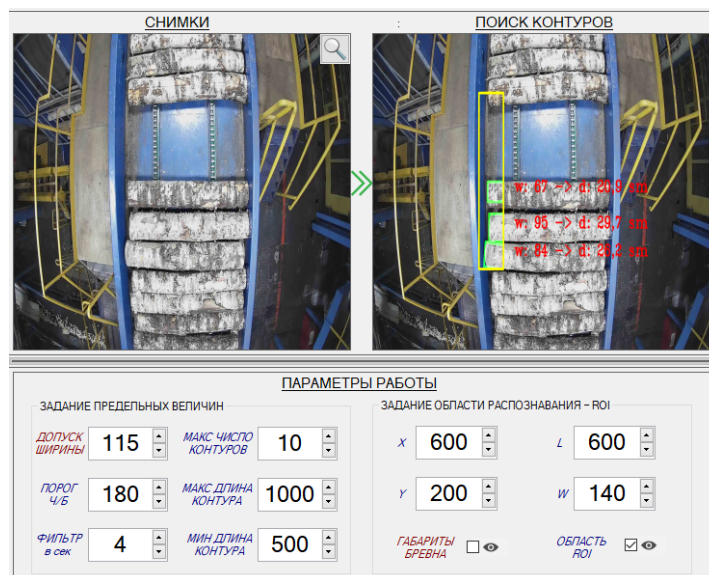
Рис. Реализация алгоритмов технического зрения на примере измерения диаметра березовых чураков на конвейере
