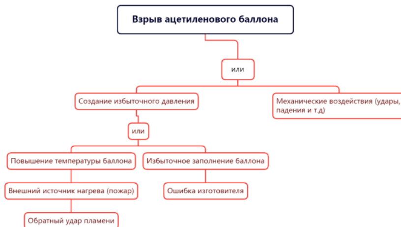
Рис. Дерево отказов взрыва ацетиленового баллона
