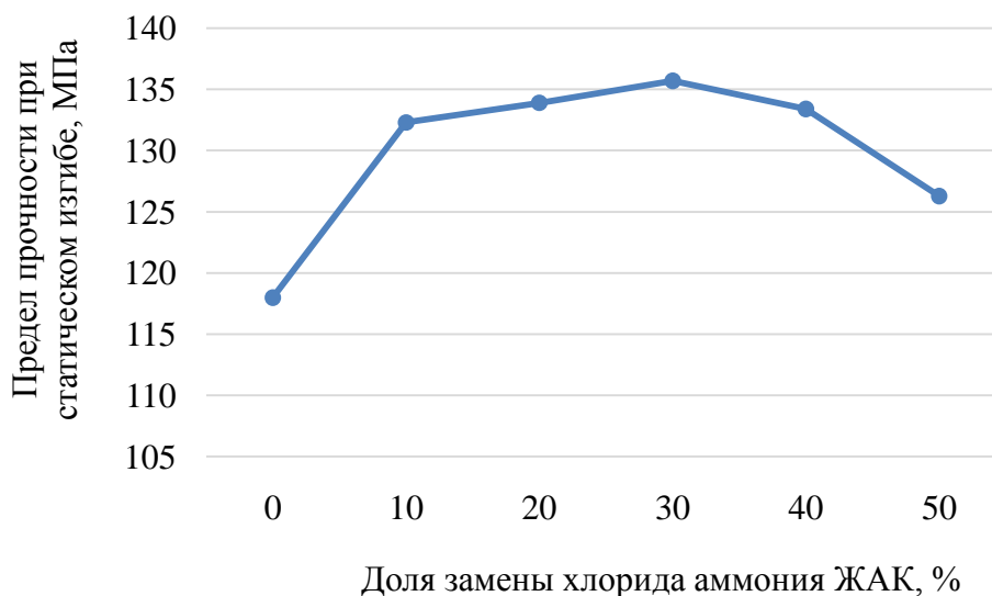
Рис. Влияние доли замены хлорида аммония железоммонийными квасцами на предел прочности фанеры ФК при статическом изгибе
