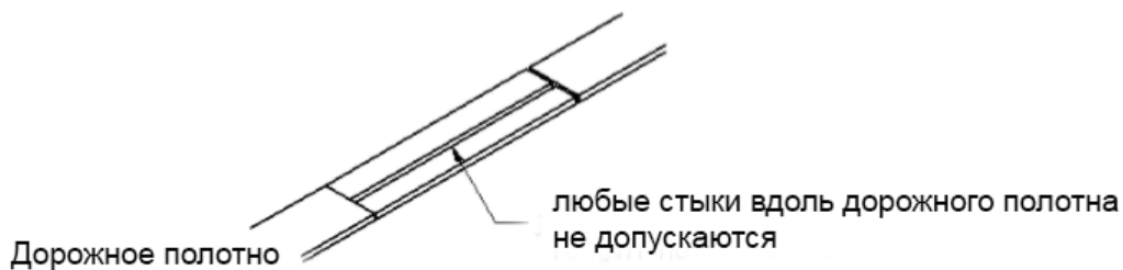
Стыки вдоль дорожного полотна
