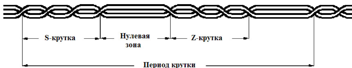
Рис. 1. Общий вид пряжи самокрученной структуры
