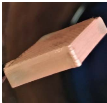
Рис. 6. Последовательность «затяжки» металлом поверхности образца из токопроводящего пластика VOLTA
