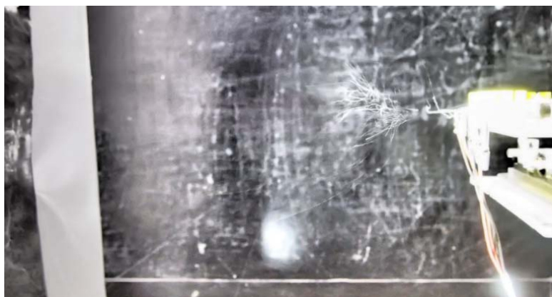
Рис. 4. Процесс электроформования на разработанной установке
