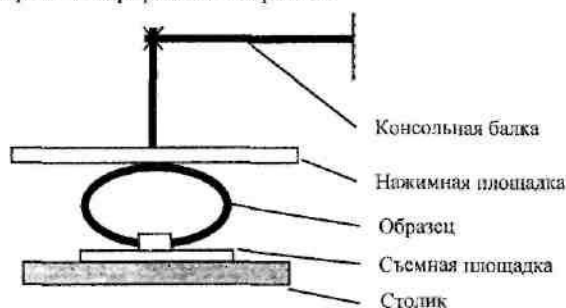
Рис.2. Конструкция датчика силы
