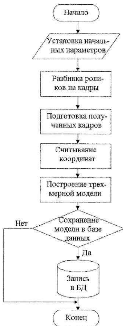
Рис. 1. Алгоритм получения трехмерной модели паковки
