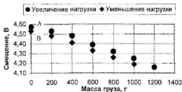
Рис. 2. Смещение опушки ткани при нагружении и разгрузении основы
