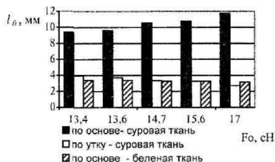
Рис.2. Диаграмма зависимости устойчивости ткани к осыпаемости ( l_b ) от натяжения основных нитей ( F_0 )
