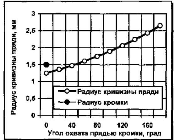
Рис.2. Радиус кривизны пряди в зависимости от угла охвата ею кромки бильной планки. \mu = 0,18 \text{ кг/м} ; \omega = 32 \text{ рад/с} ; \zeta_0 = 45^\circ ; r = 0,0015 \text{ м} ; R = 0,37 \text{ м} ; \varphi_k = 180^\circ ; T_0 = 25 \text{ Н/м} ; \frac{dV_r}{dt} = 200 \text{ м/с}^2 .
