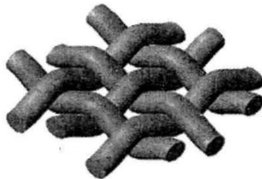
Рис.1. Пример структурного фрагмента текстильной матрицы для случая полотняного переплетения
