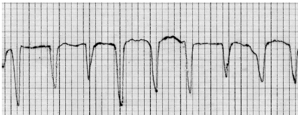
Рис. 4. Участок профилограммы изношенной поверхности кулачка с явно выраженными царапинами
