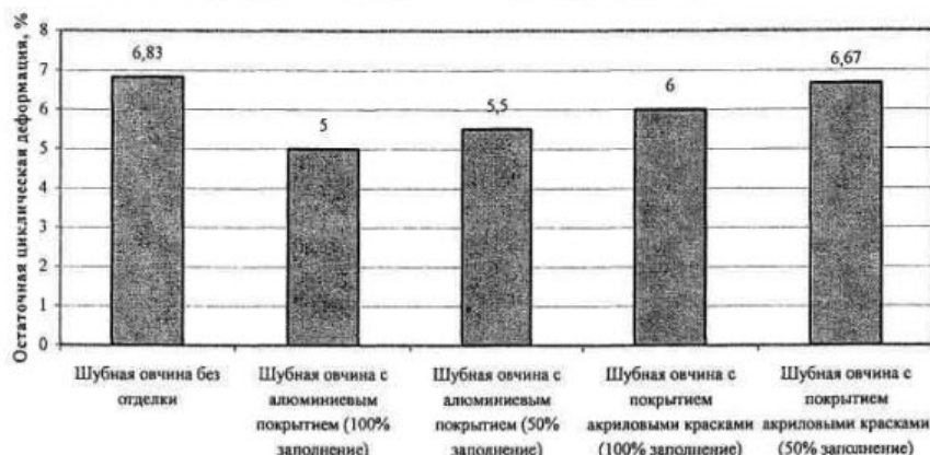
Рис. 3. Показатели остаточной циклической деформации образцов шубной овчины с различными видами отделки и заполнением поверхности
