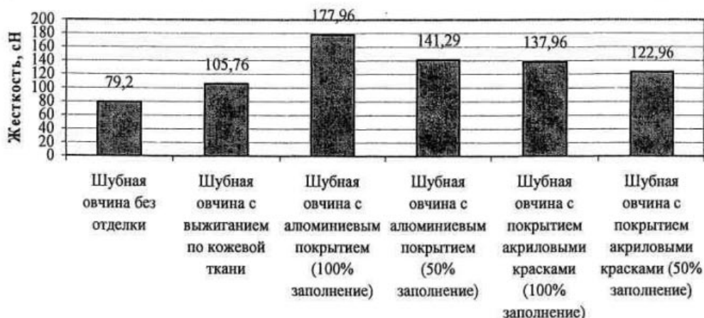
Рис. 1. Показатели жесткости образцов шубной овчины с различными видами отделки
